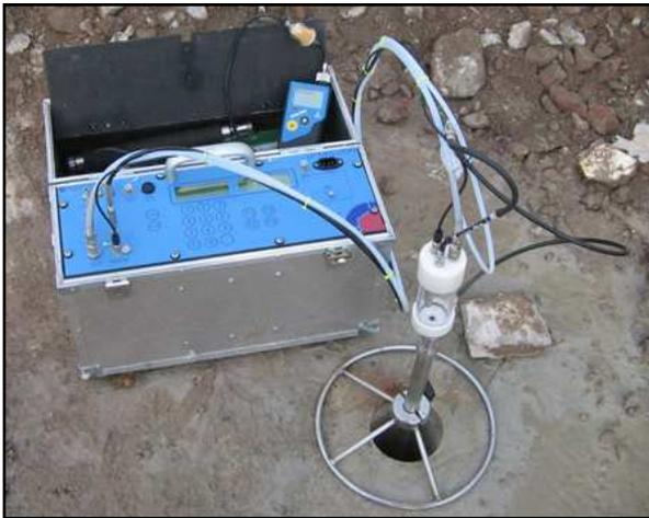
Das Honold G200-X integriert in einzigartiger Weise alle Funktionen der Probenahme, Gasmessung und Bohrlochpacker in einem System. Es zeichnet sich durch das 2-Kanal-Probenahmesystem, die innovative CO<sub>2</sub>/O<sub>2</sub>-Autokonstanzmessung, das neuartige Aquastop-System, die vorprogrammierten Meßverfahren und den Favoriten-Speicher aus.
