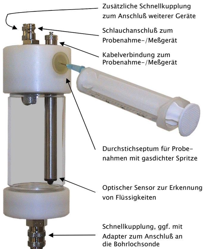
**Das Aquastop-System** dient zum sicheren Schutz der Probenahme- und Meßsysteme der G-Baureihen von Honold Umweltmeßtechnik vor einer Kontamination mit angesaugtem Grundwasser bei Bodenluft- und Deponiegasmessungen.
