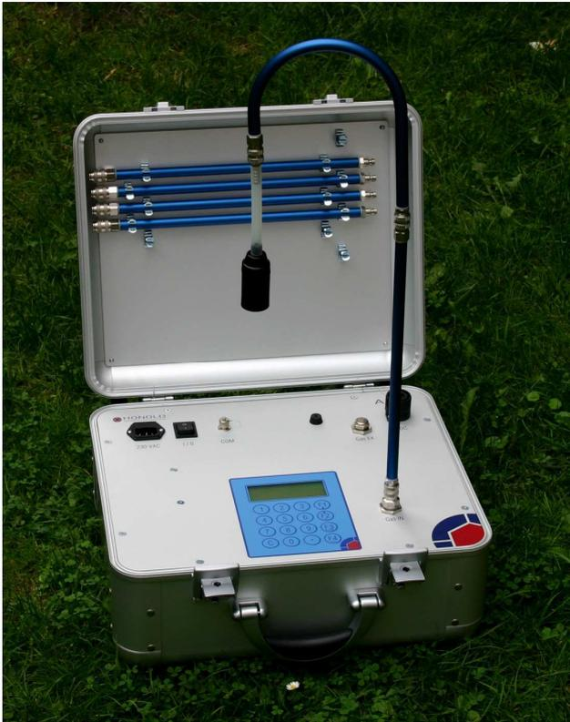
**Das Honold A120** ist das leistungsfähige Luftprobenahmesystem für z.B. Probenahmen von luftgetragenen Schadstoffe wie Fasern, Stäube, Luftkeime und Aerosole entsprechend den einschlägigen Richtlinien für die Raumluft-Untersuchung (VDI 3492, 4300er etc.).
