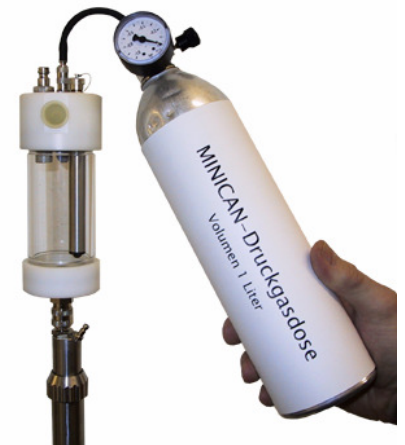
Filtermodul AS mit Aquastop-Sensor, Septum für Probenahmen mit gasdichter Spritze und Anschluß für z.B. Minican-Adapter
