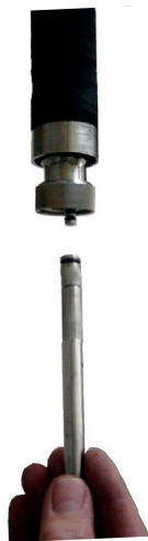
Aufnahmekammer für Adsorber-Röhrchen in der Sondenspitze
